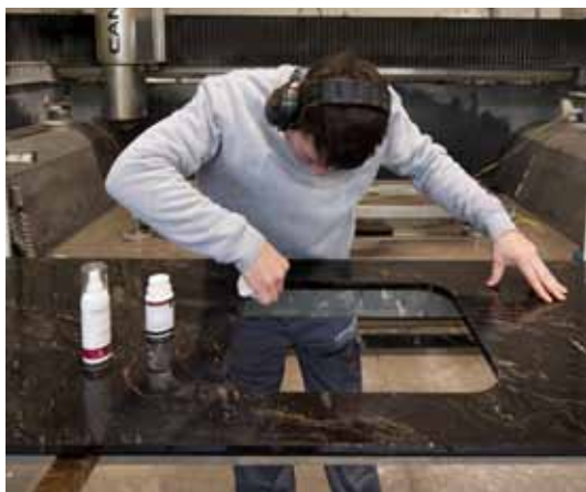
Aplicacion Colorlev en un canto pulido de un seno visto Application of Colorlev on a polished edge of a seen sink
